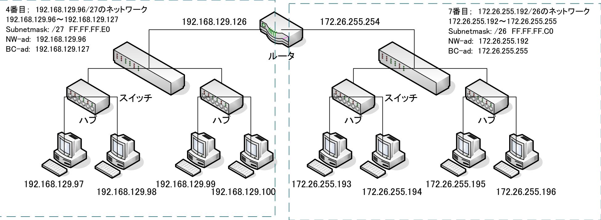
192.168.129.0/24を8個のサブネットに分けるには、サブネットマスクを8個分=2^3の3ビット分をホスト部からサブネットワーク部にする
